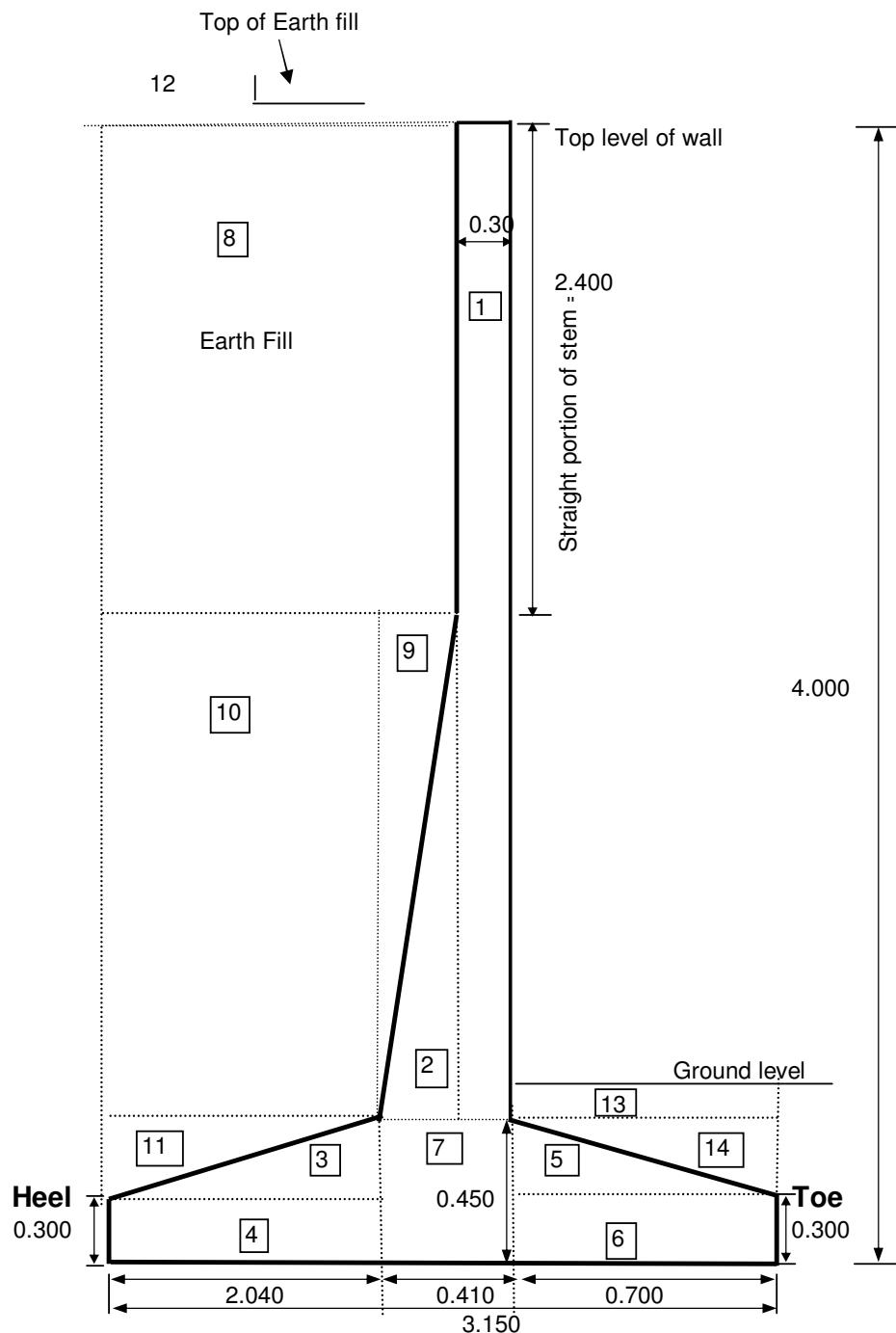
**DESIGN OF RETAINING WALL FOR 4.000 m HEIGHT**
