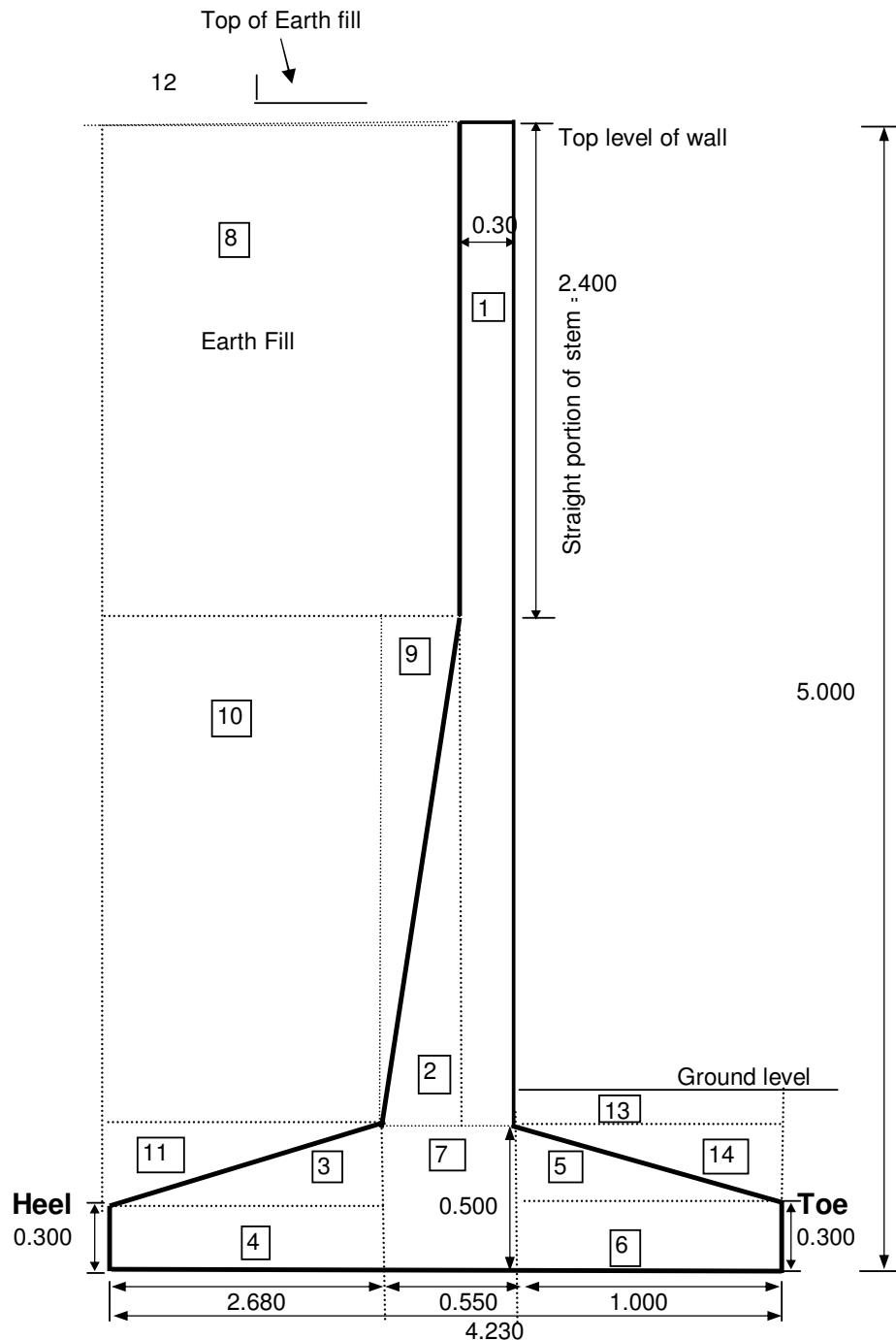
**DESIGN OF RETAINING WALL FOR 5.000 m HEIGHT****DESIGN DATA:**
