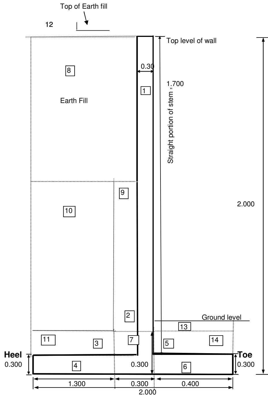
**DESIGN OF RETAINING WALL FOR 2.000 m HEIGHT****DESIGN DATA:**
