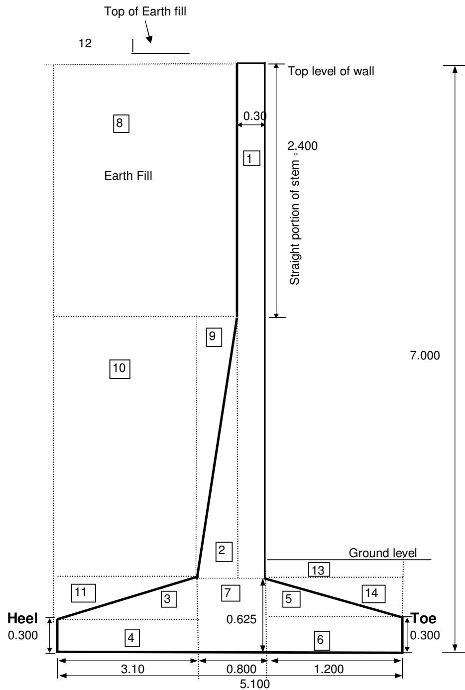
**DESIGN OF RETAINING WALL FOR 7.000 m HEIGHT****DESIGN DATA:**
