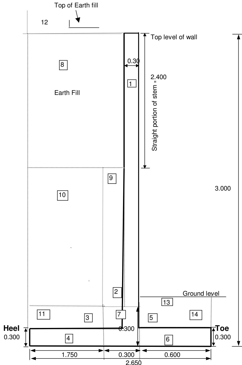
**DESIGN OF RETAINING WALL FOR 3.000 m HEIGHT****DESIGN DATA:**
