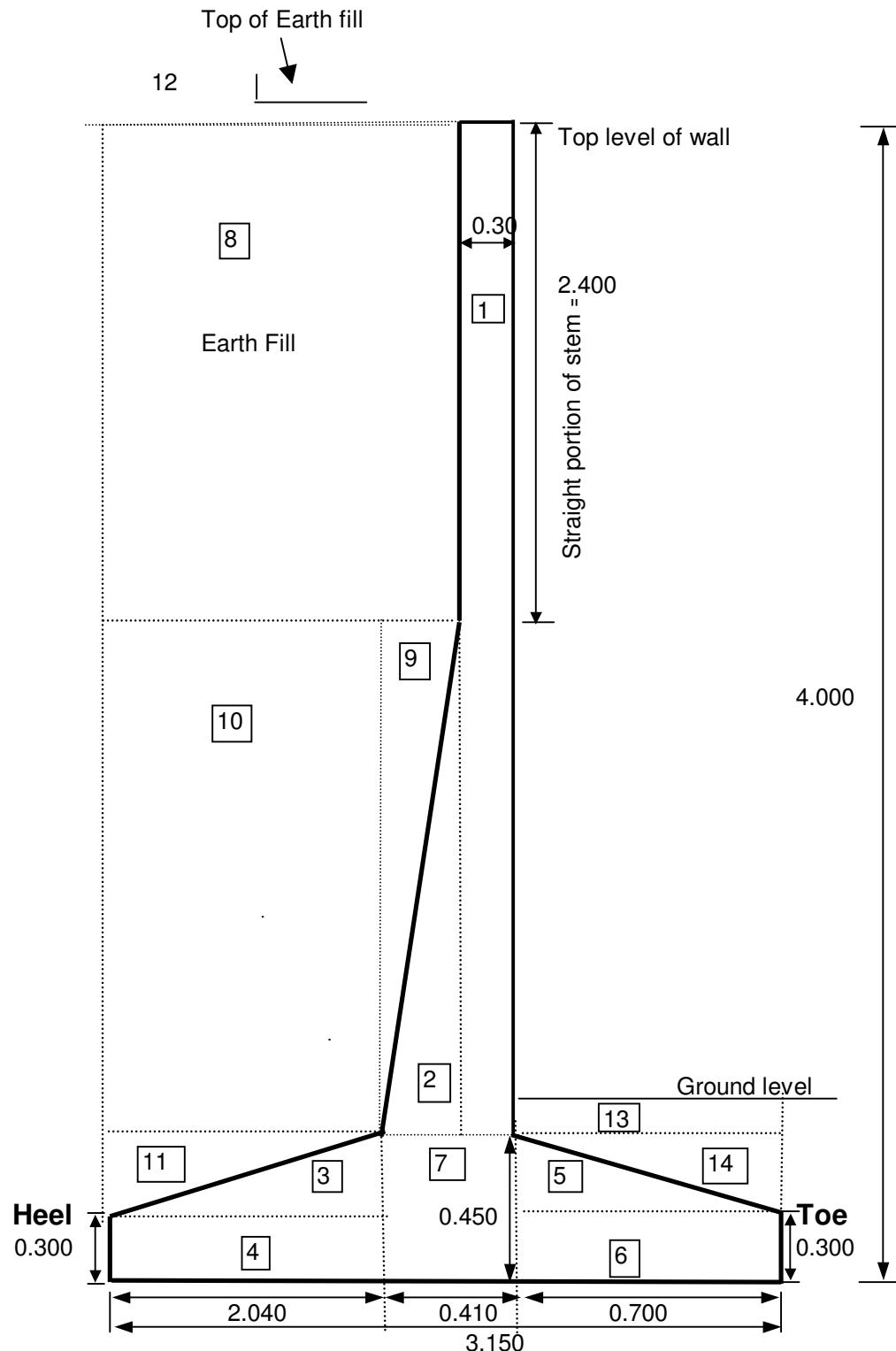
**DESIGN OF RETAINING WALL FOR 4.000 m HEIGHT****DESIGN DATA:**
