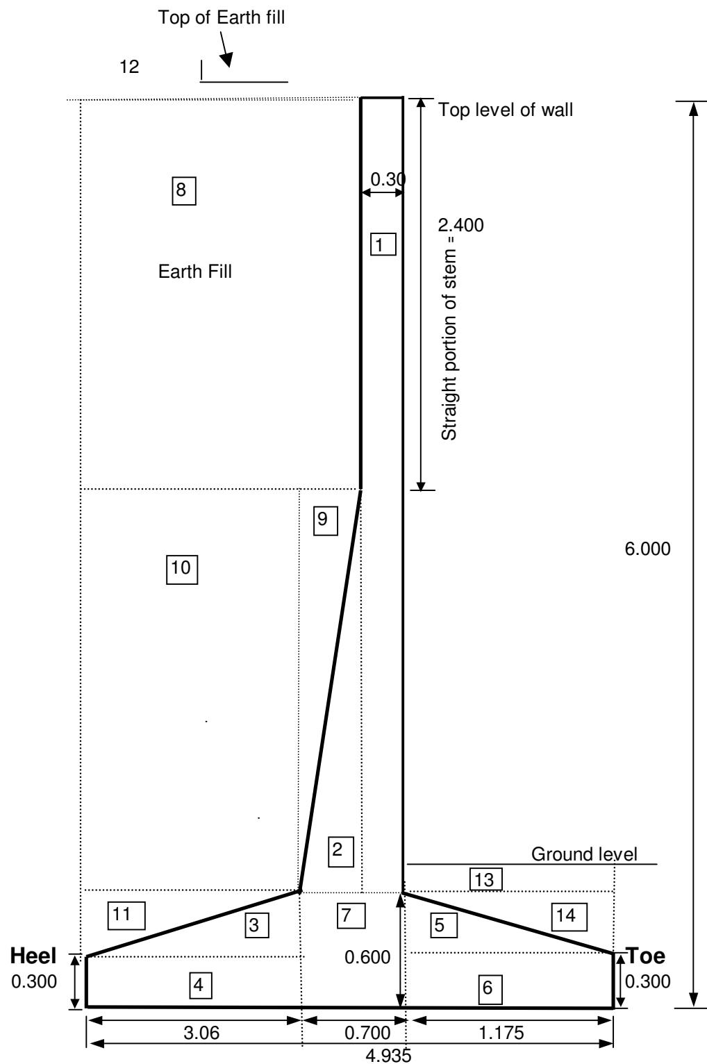
**DESIGN OF RETAINING WALL FOR 6.000 m HEIGHT****DESIGN DATA:**
